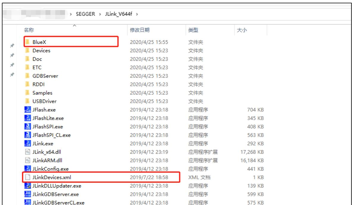
(2) 若 J-Link 安装路径下原来就存在 [JLinkDevices.xml]文件，按照以下方法处理：首先双击打开 SDK3.x 文件路径下的 [JLinkDevices.xml]文件，然后复制文件内如下图框选的内容
